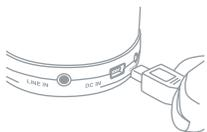
Branchez l'autre extrémité du câble de chargement dans une source d'alimentation USB (par exemple un ordinateur ou un chargeur USB).
